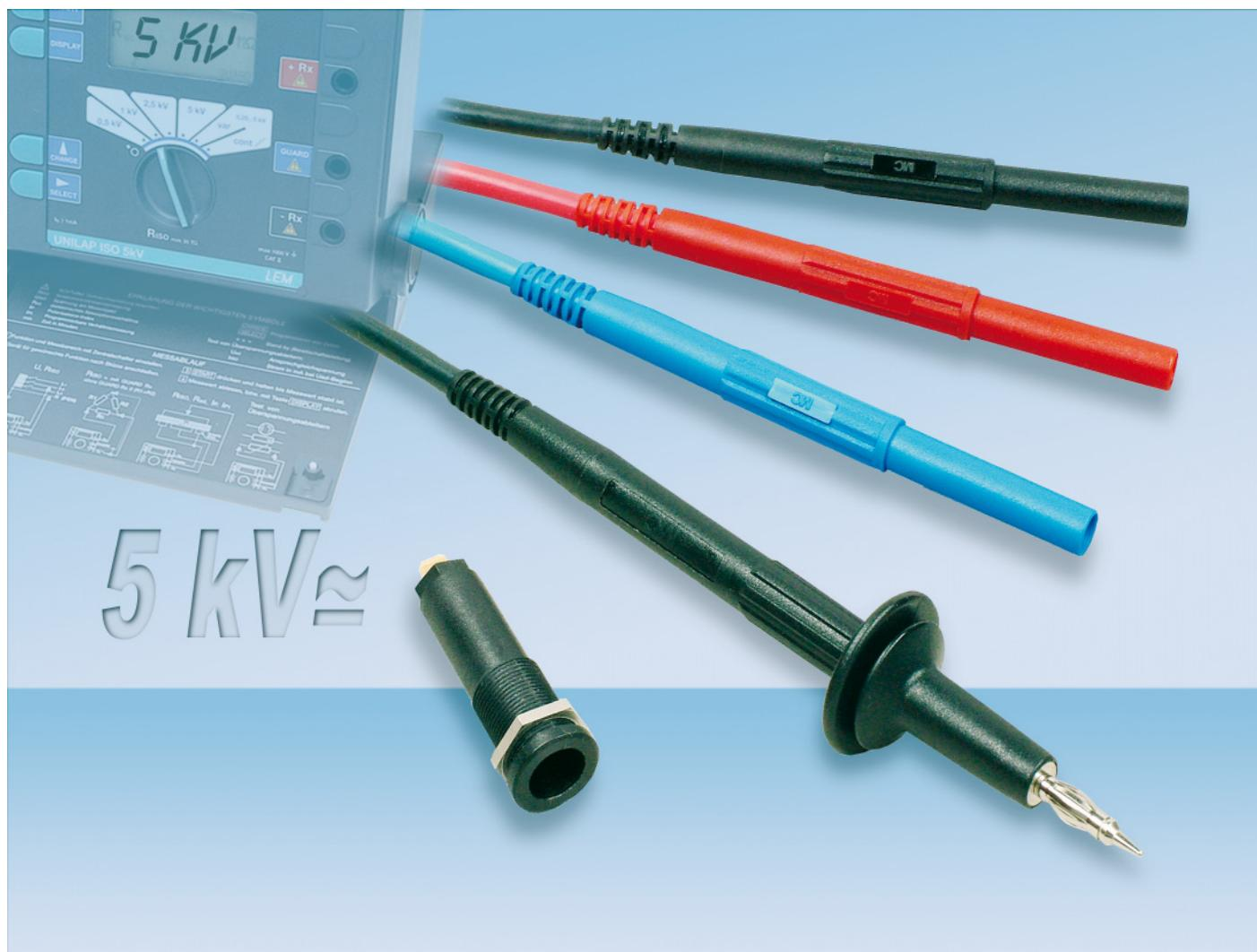
Ces accessoires de mesure sont tout particulièrement conçus pour une utilisation en combinaison avec des appareils de test d'isolation jusqu'à 5 kV. L'isolation est dimensionnée de telle sorte que les accessoires peuvent, selon la norme CEI/EN 61010-031, être manipulés par l'opérateur en cours de mesure. L'isolation en TPE du câble se caractérise par une forte impédance et se prête donc parfaitement à des mesures de résistances très élevées.
